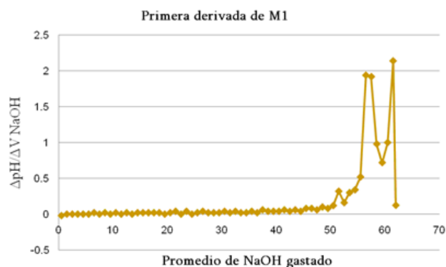
Figura 10b. Criterio de la primera derivada para determinar el punto máximo y mínimo de la curva de titulación de M1
